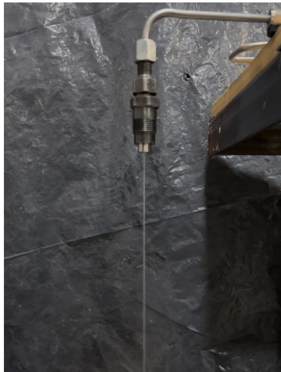
Imagen 43: Inyección sin precarga en el resorte
