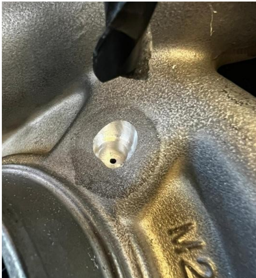
Imagen 10: Perforación en la voluta para toma de presión
