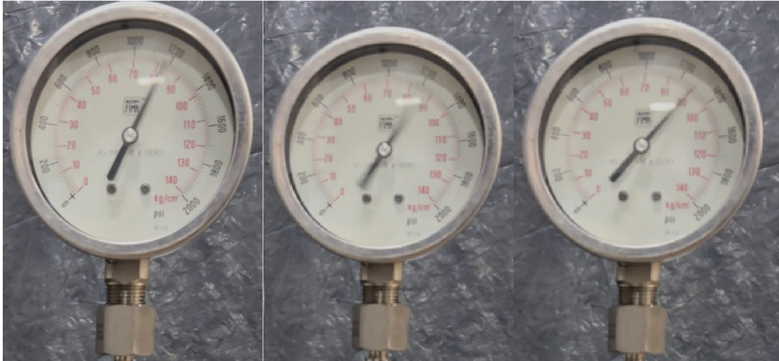
Imagen 44: Variación de presión en una décima de segundo - suplemento 1 mm
