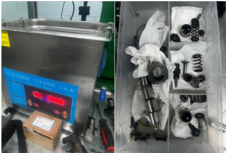
Imagen 22: Limpieza por ultrasonido
