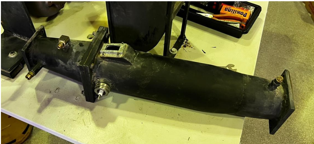
Imagen 4: Cámara de combustión desmontada
