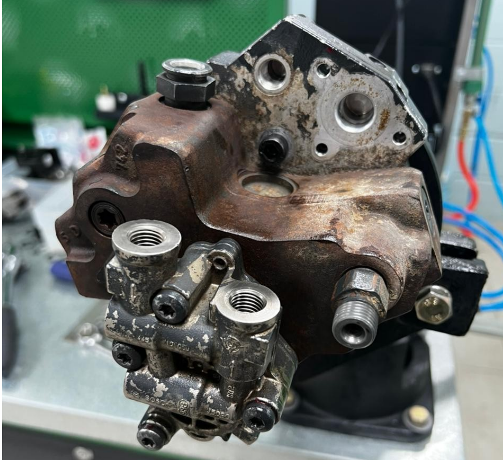
Imagen 19: Bomba de inyección antes del desarme y limpieza
