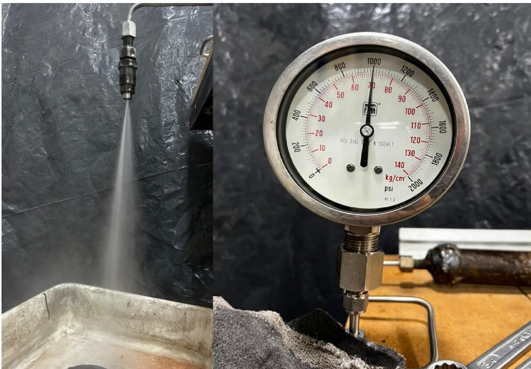
Imagen 52: Pulverización y Presión a 17 Hz
