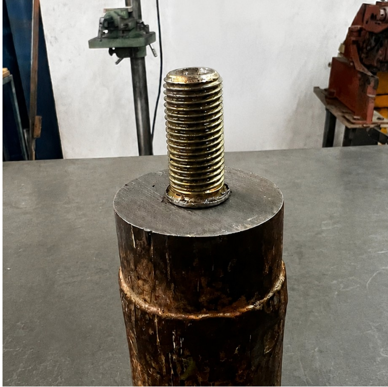
Imagen 39: Conector de alta presión posicionado para ser soldado
