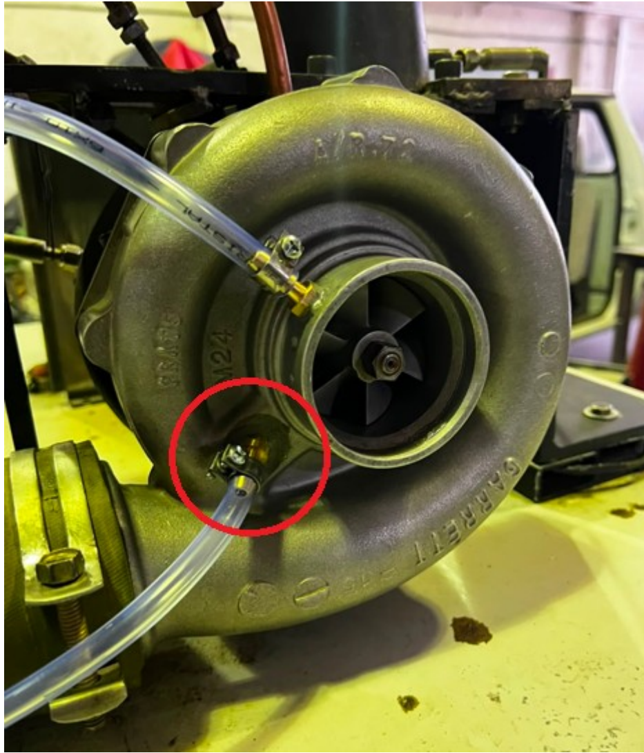
Imagen 11: Toma de presión - Periferia del rodete del compresor
