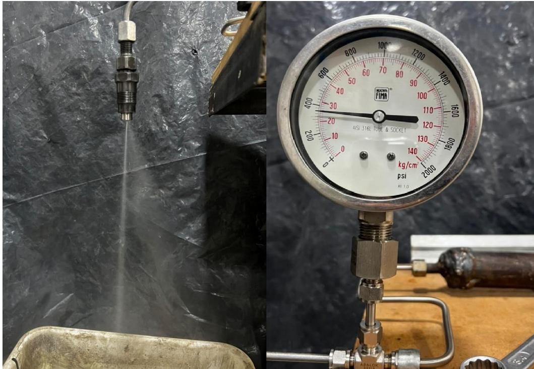
Imagen 47: Pulverización y Presión a 7 Hz
