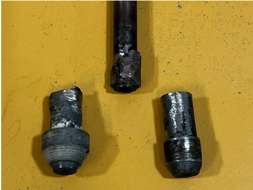
Imagen 29: Fractura de la unión por soldadura - Acero Inoxidable con Acero al carbono
