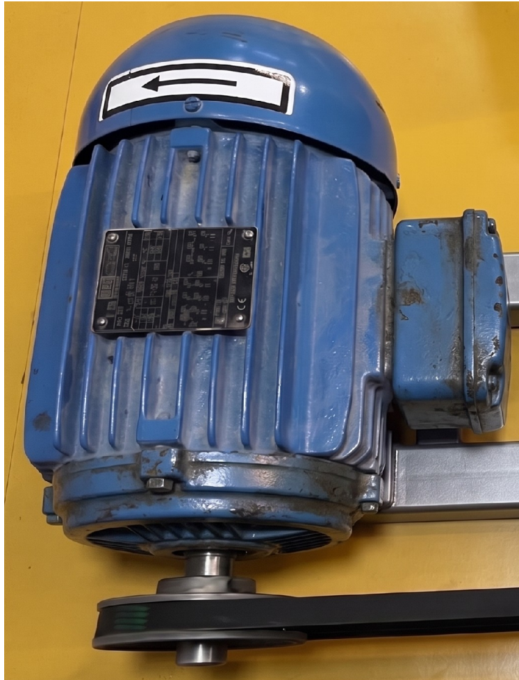
Imagen 26: Motor trifásico de 1.5HP
