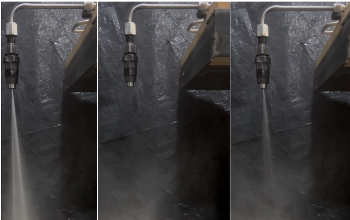
Imagen 45: Pulsación de inyección en una décima de segundo - suplemento 1 mm
