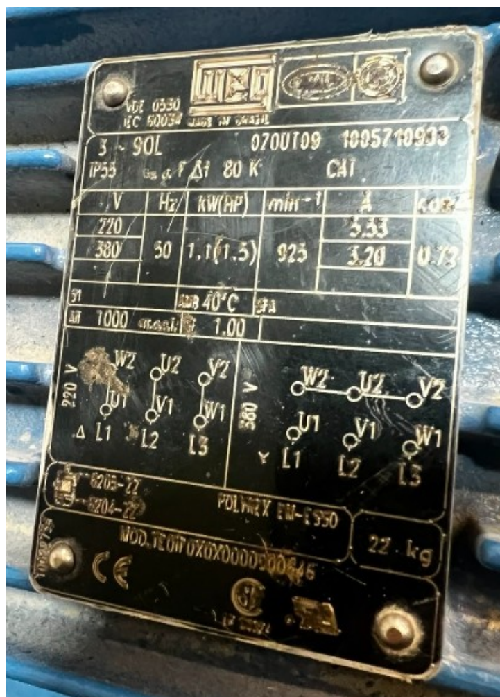
Imagen 32: Datos del motor trifásico
