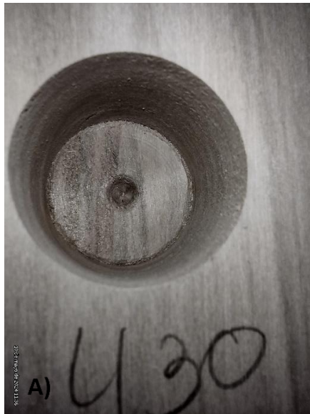
Figura 24. A) Perforación con borde sin defecto de astillado realizado a 430 RPM. B) Perforación con borde sin defecto de astillado realizado a 2100 RPM.
