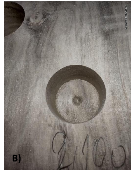
Figura 24. A) Perforación con borde sin defecto de astillado realizado a 430 RPM. B) Perforación con borde sin defecto de astillado realizado a 2100 RPM.
