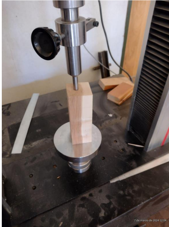
Figura 12. Determinación de la dureza del duramen de la cara transversal de una probeta mediante el ensayo de penetración de una bola de acero.
