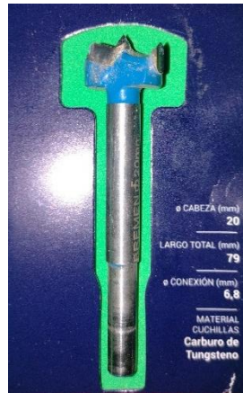
Figura 16. Broca Forstner de punta de carburo de tungsteno; dos filos de corte: principal y periférico
