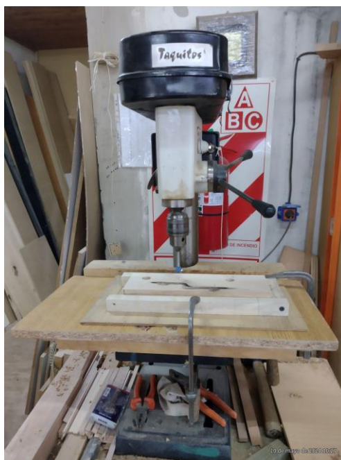
Figura 15. Taladro de banco marca barbero con un motor de ½ HP de potencia.
