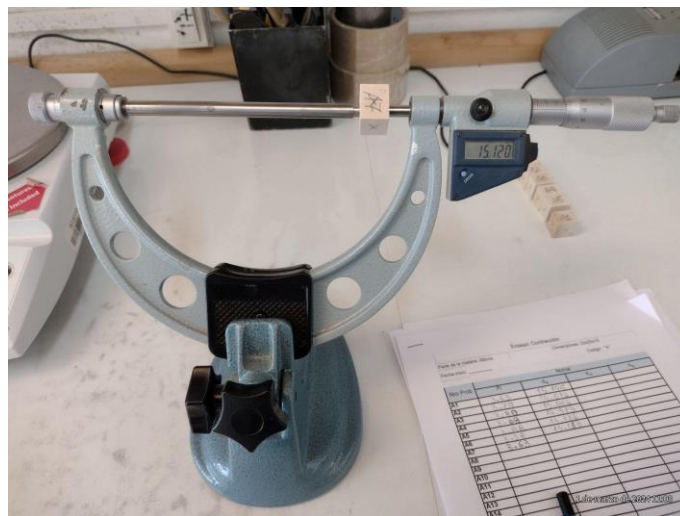
Figura 9. Micrómetro marca Mitutoyo, precisión de 0,001 mm.
