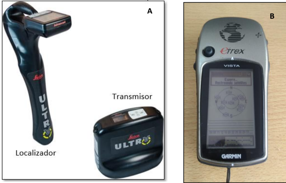
Fig. 5: A: Equipo portátil "Leica Ultra Advanced" compuesto por el transmisor y localizador. B: GPS "Garmin E Trex".
