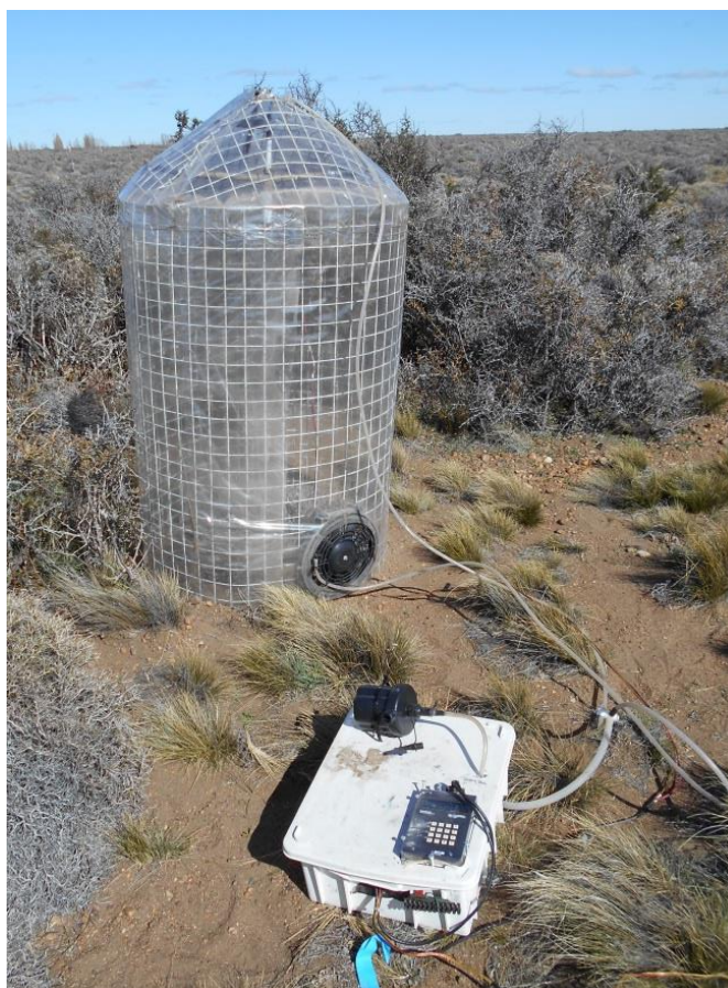
Figura 4.2. Open top chamber utilizada para medir la transpiración de las plantas.
