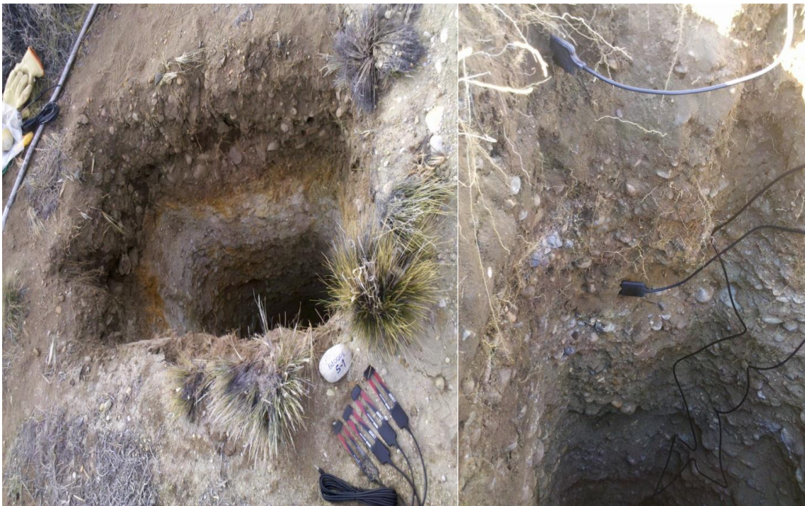
Figura 1.14. Imagen de una de las excavaciones realizadas en el sitio de estudio con los sensores ECHO que se instalaron a 10, 40, 100 y 200 cm de profundidad en 2013 para determinación del contenido volumétrico de agua del suelo.
