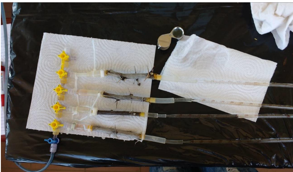
Figura 4.1. Sistema para medir conductividad hidráulica de tallos.
