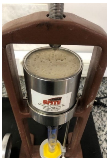
Imagen 4 Muestra de fluido de perforación dentro de la celda del filtro prensa.
