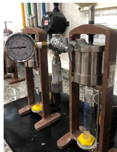
Imagen 5 Proceso de filtración en marcha mostrando una presurización a 100 psi.
