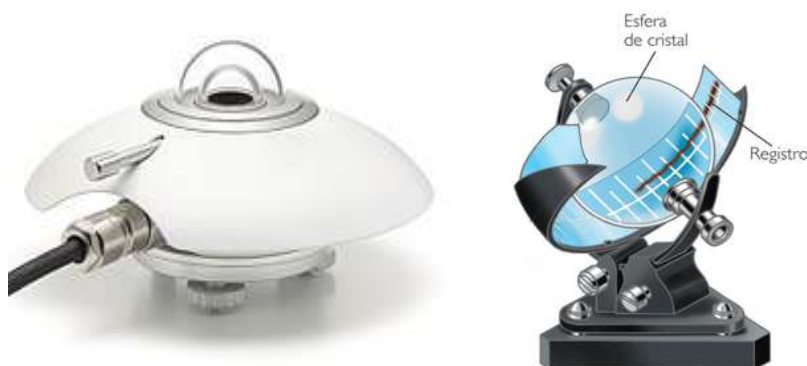
Figura 2.6: piranómetro para medir irradiación solar (izquierda) y heliógrafo de Campbell-Stokes para medir heliofanía (derecha).
