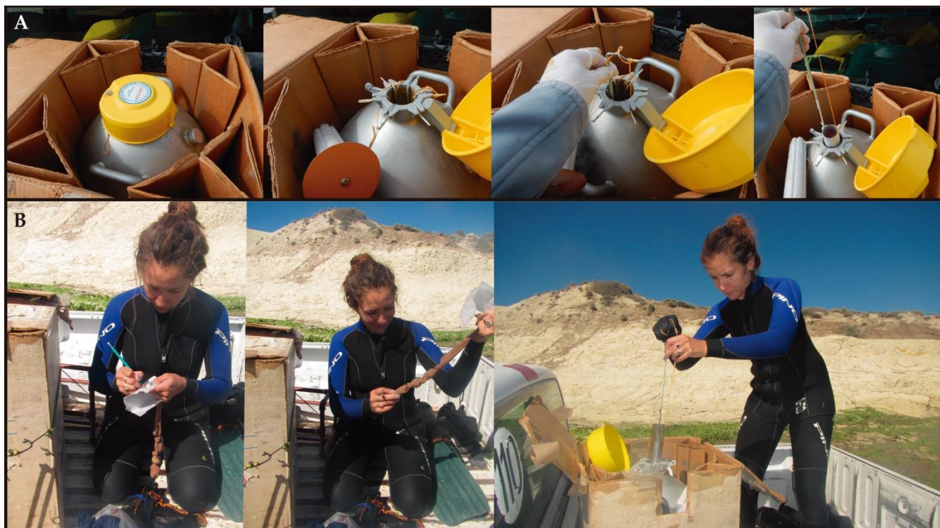
Figura 3.1: A- Detalle del termo de nitrógeno y sus canister . B- Rotulado y almacenado de los individuos para su traslado en el termo de nitrógeno desde el sitio de muestreo al laboratorio.
