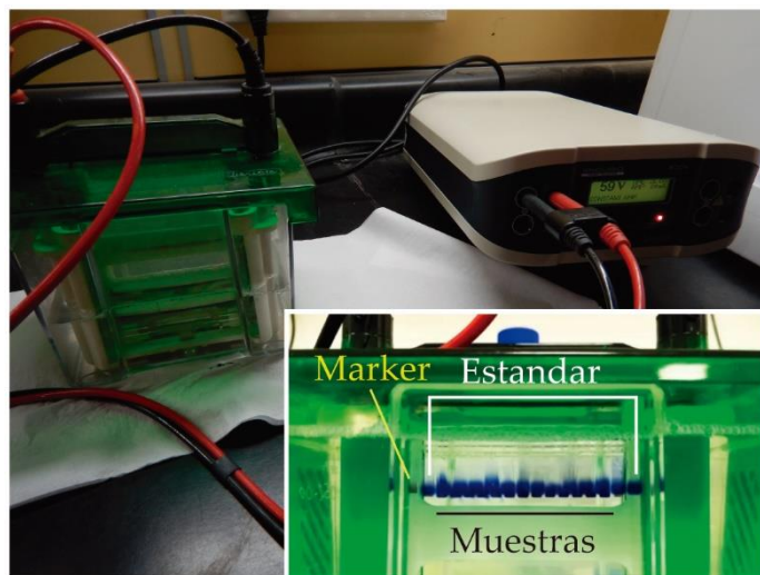
Figura 3.2: Fuente de poder conectada a la cuba de electroforesis, detalle de sembrado en gel de poliacrilamida de 15 calles.
