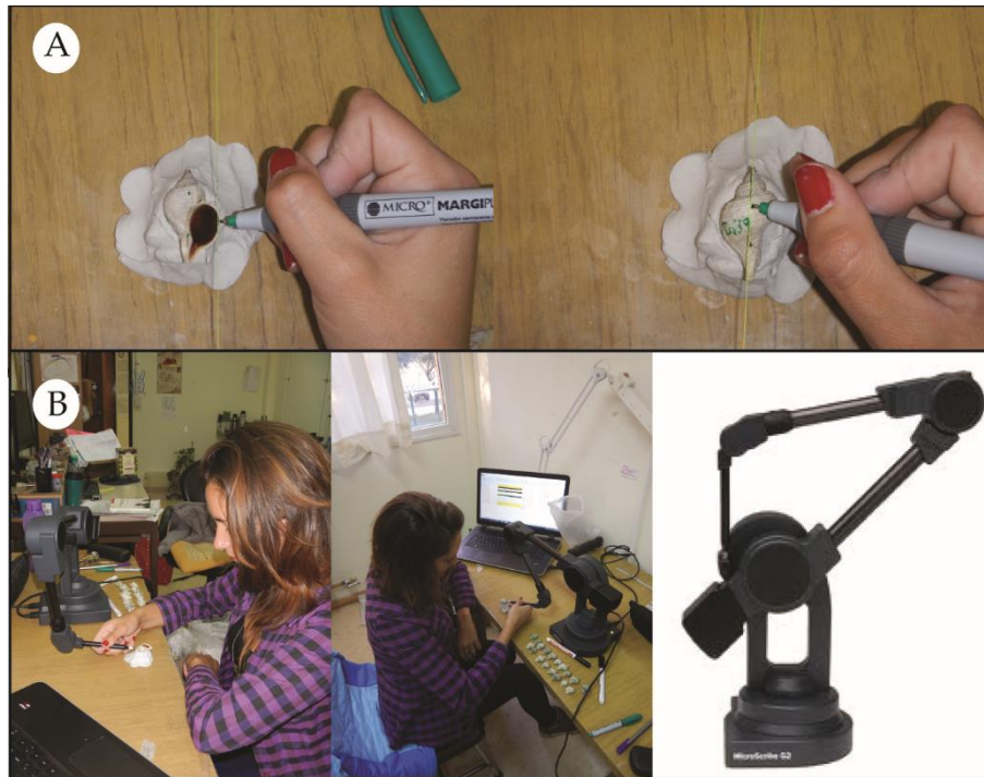
Figura 2.2: Proceso de digitalización. A- Marcado de los 17 puntos con tinta. B- Extracción de la coordenada del punto con el brazo digitalizador Microscribe.
